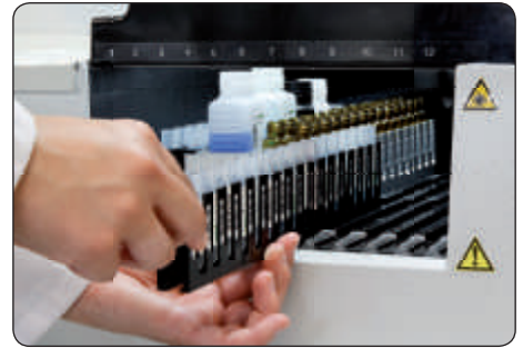
Zona de gradillas
